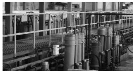
**предлагает бессточную систему малоотходной технологии (МОТ) с замкнутым циклом использования промывных вод процессов покрытий на установке регенерации промывных вод (УРПВ) с уникальным минерально-углеродного сорбента (МУС)**
